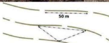
Imagen 5. Separación entre cordones y acomodo en tresbolillo Fuente: Ejido Nacastillo, mpio. La Huerta
